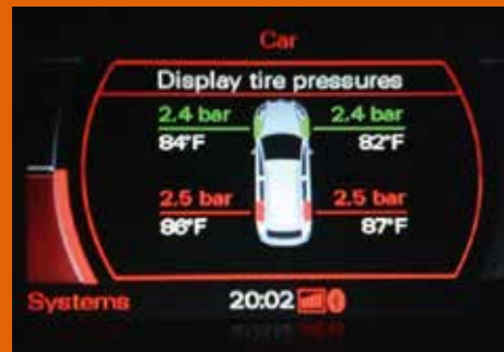
TPMS direct systeem: in elke band zit een sensor die de spanning meet.
