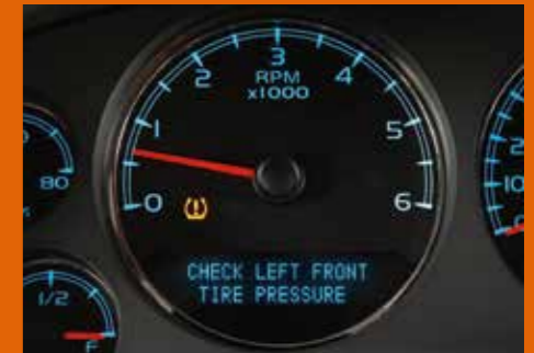
TPMS indirect systeem: de software van de auto herkent een afwijking.
