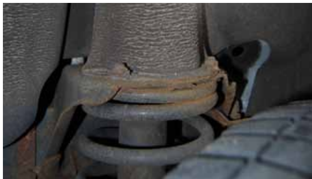
Foto 1: Chassis rust via steun op veerschotel.
