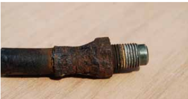
Breuk als gevolg van corrosie.
