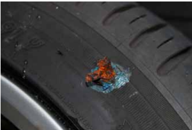
Onjuist uitgevoerde reparatie, dus afkeur.
