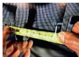
Meet de slag van de remcilinder op. Bij deze cilinder, type 24, is dat 75 mm.
