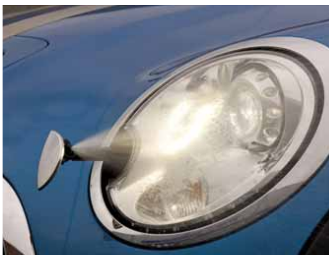
Voertuigen met datum eerste toelating van na 31 december 2006 die zijn voorzien van gasontladinglichtbronnen moeten onder meer gecontroleerd worden op een goedwerkende koplampreinigingsinstallatie.
