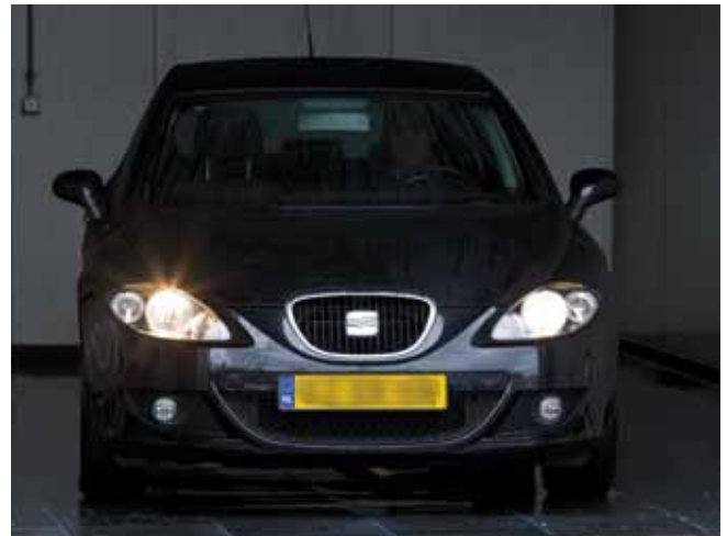
Verblindend licht, met daardoor ook onjuist lichtbeeld, door verkeerd gemonteerde lamp.
