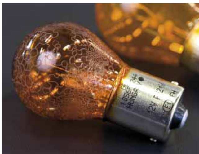
Na verloop van tijd kan de lak/coating van het lampje barsten en zal de (zij)richtingaanwijzer te veel wit licht uitstralen in plaats van de voorgeschreven ambergele kleur.
