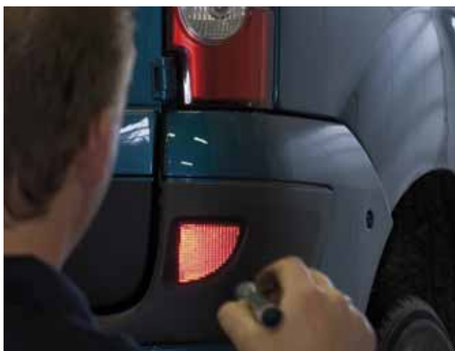
Met een zaklamp is de goede werking van de rode retroreflector te controleren.
