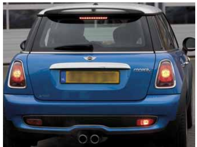
Wordt vaak vergeten bij voertuigen van voor 1998: mistlicht achter is dan niet verplicht, maar als het aanwezig is moet het wél voldoen aan bepaalde eisen en dus onder meer de plaatsing in het midden of links van het midden.
