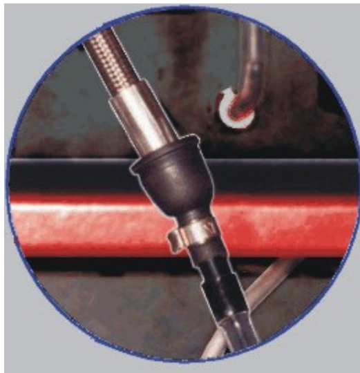
Figuur 14. Verbinden van de lekttestadapter
